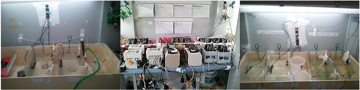
Figure 15. Dispositif expérimental pour la première expérience. A gauche, les bacs témoins mâles et femelles. Au centre le dispositif de contrôle du pH, du renouvellement de l'eau et du maintien de la contamination. A droite les bacs contaminés à 20 et 2 \mu\text{g.L}^{-1} .
