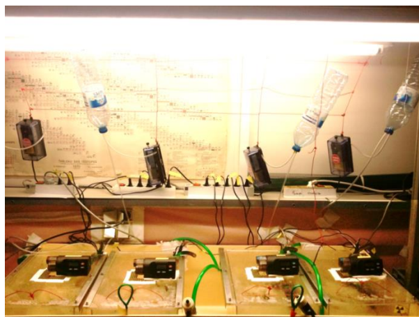
Figure 16. Dispositif expérimental de la seconde expérience en système fermé. Le renouvellement de l'eau des bacs s'effectue par le biais d'un aspirateur à eau. La contamination des bacs en uranium a été effectuée par ajout manuel.
