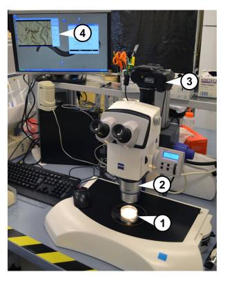
**FIGURE 3.1** Montage permettant de visualiser et de photographier les nématodes. ① : Boîte de Petri contenant le(s) nématode(s) ; ② : Stéréo-microscope ; ③ : Appareil photo numérique ; ④ : Logiciel de visualisation en direct et de prise de vue.
