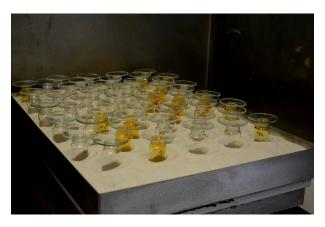
**FIGURE 3.3** Phase d'incubation de l'acide nitrique avec reflux durant la minéralisation. Les verres de montre ralentissent l'évaporation et favorisent la digestion de la matière organique.
