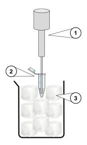
**FIGURE 5.1** Dispositif de sonication des échantillons de larves L1 *C. elegans*. ① : microsonde de sonication en escalier (2 mm) permettant la sonication de faibles volumes (150  $\mu$ L - 5 mL); ② : Larves L1 décongelées dans le tampon de lyse; ③ : Bain de glace permettant d'éviter une élévation trop importante de la température engendrée par la sonication.
