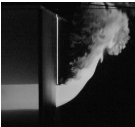
Figure C-74: Image du panache déversant obtenue par tomographie laser dans la maquette isotherme
