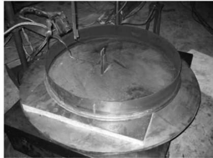
Figure D-8: Photographie d'un des bacs en acier noir utilisé en tant que terme source lors des essais menés à grande échelle
