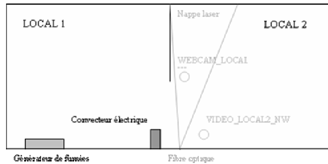
Figure F-14: Mise en place du montage expérimental vu du côté sud pour les tests de qualification
