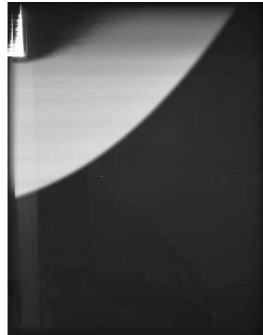
Figure B-62: TEST AVEC DILUTION Visualisations par tomographie laser de l'écoulement à la porte pour le test 2 ( q_{\text{He}} = 100 l/min, 100% He à l'injection)
