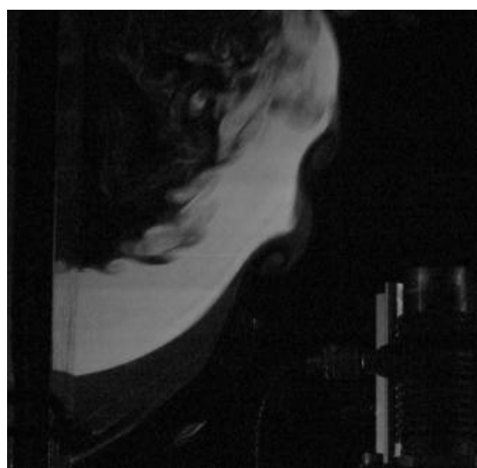
Figure C-75: Image du panache déversant obtenue par tomographie laser dans la maquette thermique
