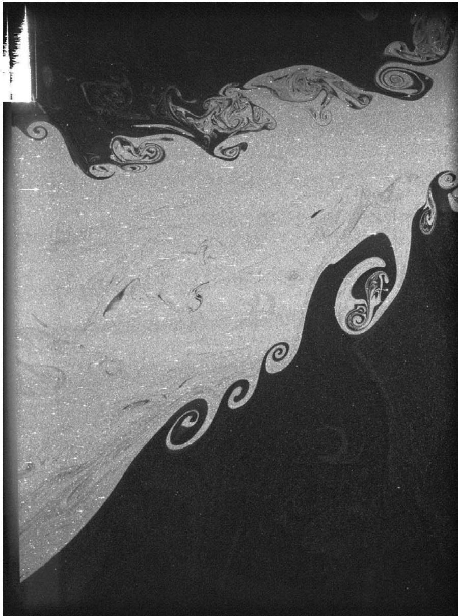
Figure F-20 : Visualisation par PIV de l'écoulement à la porte dans la maquette isotherme, q_{He} = 150 l/min
