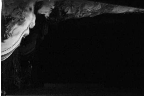
Figure C-48: Image obtenue par visualisation par tomographie laser réalisée dans le local "cible" ( D_{Bac} = 130 mm)
