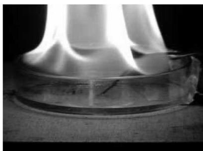
Figure C-26: Photographie de la flamme pour le bac pyrex ( D_{\text{bac}} = 89 \text{ mm} ) à t = 400\text{s}
