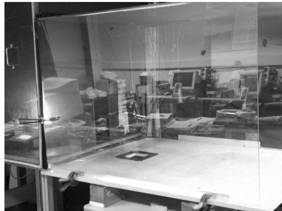
Figure C-6: Photographie du local "cible" de la maquette thermique
