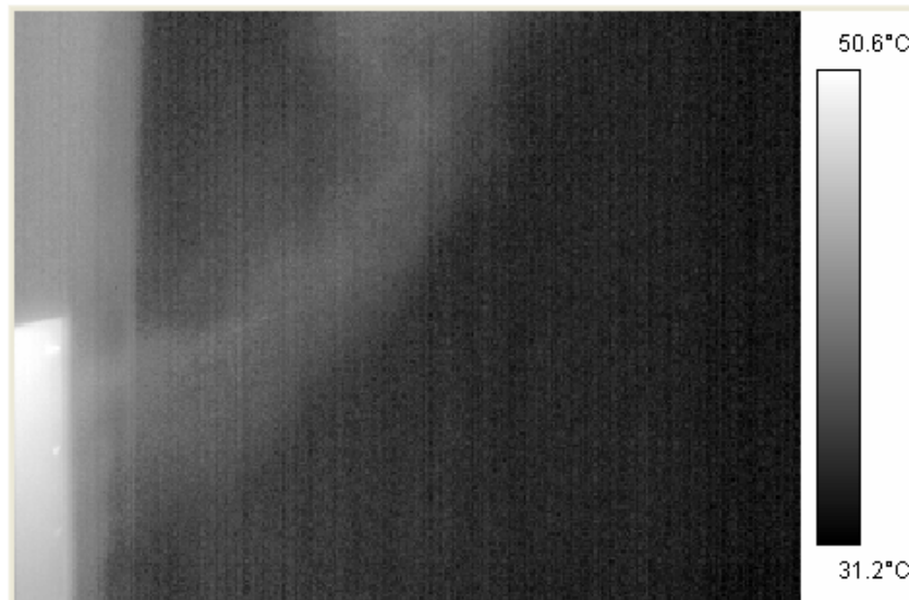
Figure C-59: Image du panache déversant obtenue par caméra infra rouge ( D_{\text{Bac}} = 100 \text{ mm} )
