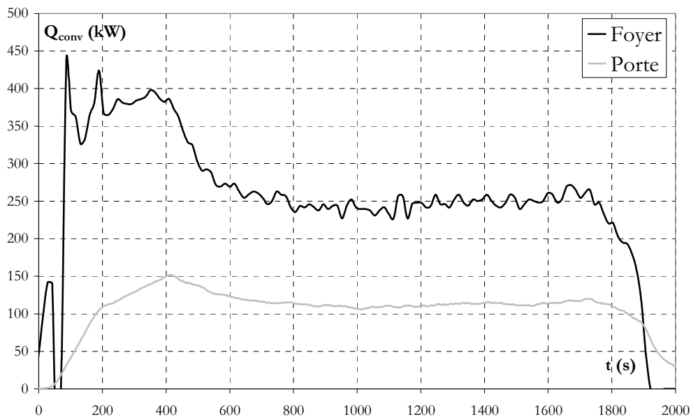
Figure D-30: Evolutions temporelles des puissances convectives au foyer et à la porte
