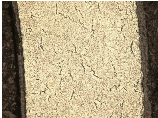
FIG. 4.2 – Observations au microscope optique de l'échantillon RX40_5, oxydation en air à 470°C pendant 56 jours
