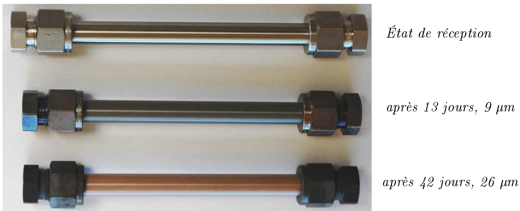
FIG. 4.6 – Photographies de tronçons de gaine (Zy-4 RXA) à différents temps de l'oxydation en air à 470°C
