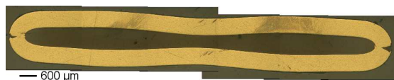
FIG. 5.4 – Observation au microscope d'un anneau en Zy-4 SRA non oxydé après un essai RCT à 20°C
