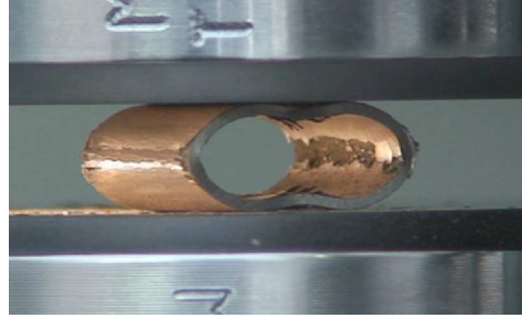
FIG. 5.15 – Photographie de l'échantillon SR60_1 prise au cours de l'essai RCT à un déplacement de la traverse d'environ 4 mm
