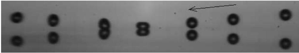
FIG. IV.2 – Déformation d'une goutte de décane :  $D_g = 50 \mu\text{m}$ ,  $V_n = 1 \text{ m}\cdot\text{s}^{-1}$ ,  $f_{inj} = 10 \text{ kHz}$ ,  $T_p = 300^\circ\text{C}$ .
