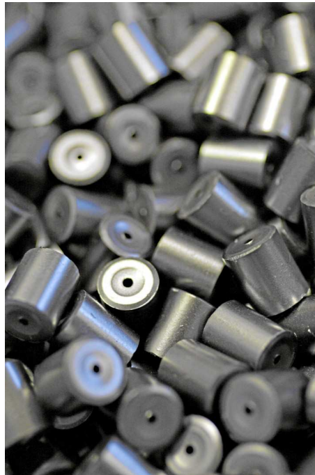
FIGURE 1.2 – Pastilles de combustible nucléaire
