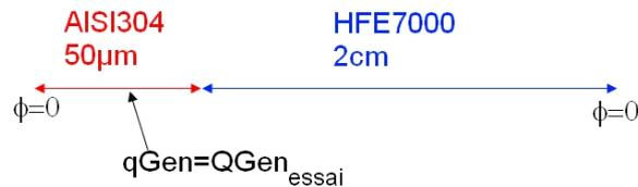
FIGURE 4.1 – Schéma du modèle 1D de la simulation numérique.
