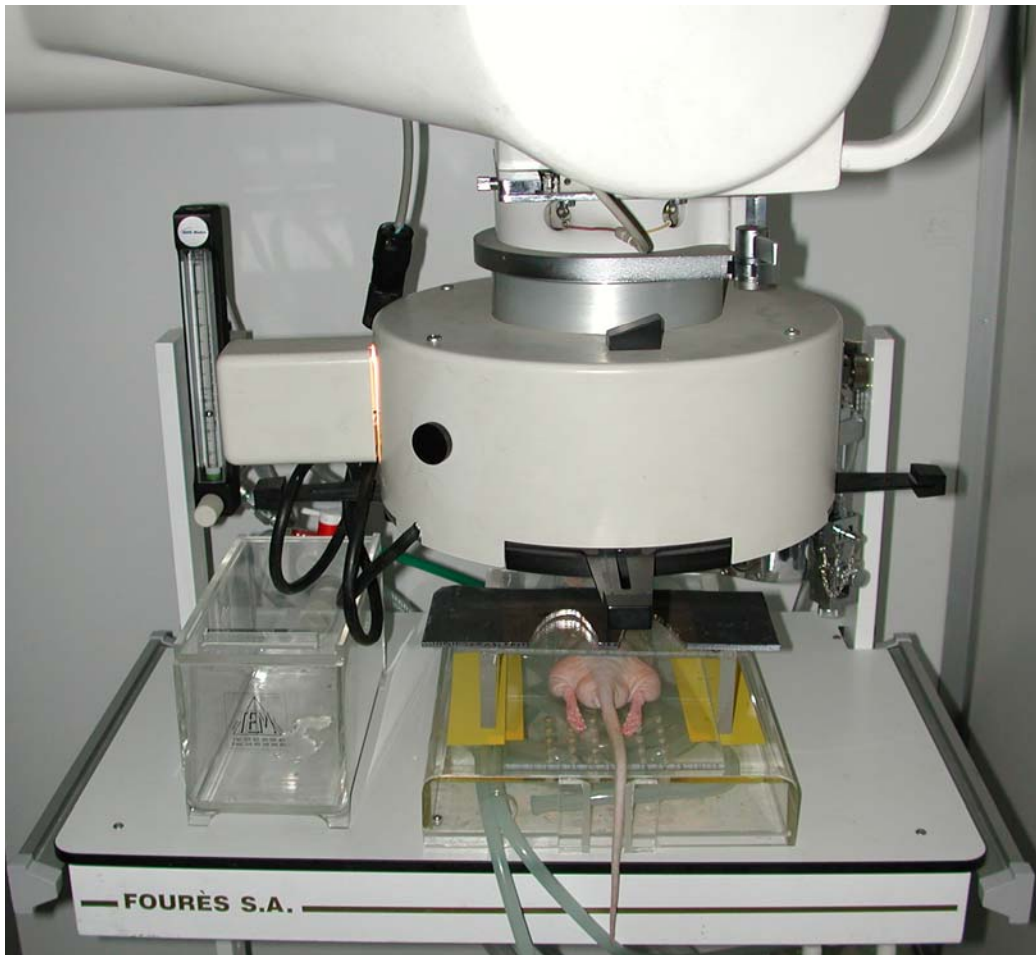
Photographie du dispositif d'anesthésie et d'irradiation (générateur de rayons X, Institut Gustave Roussy, Villejuif). Les rats anesthésiés sont placés sous la tête du générateur. Une protection de plomb limite l'exposition aux pattes postérieures.
