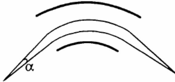
Figure AII-2. Focalisation en direction dans un secteur électrique.
