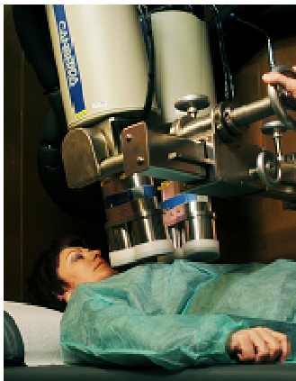
Figure 3-1 : Mesure pulmonaire réalisée avec le système à quatre détecteurs germanium du LEDI sur le site du Vésinet.
