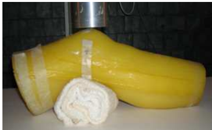
Figure 4-52 : Fantôme physique d'étalonnage pour la mesure du genou (CIEMAT, Espagne).
