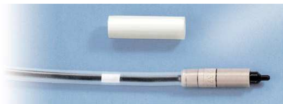
Figure III.2- Chambre d'ionisation compacte du type CC01 fabriquée par la société IBA. Elle a été utilisée pour les mesures de profils de dose latéraux (figure adaptée de IBA, 2007).
