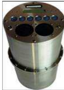
Figure IV.6- CPET du type Hawk utilisé pour la mesure de H^*(10) dans la salle de traitement.
