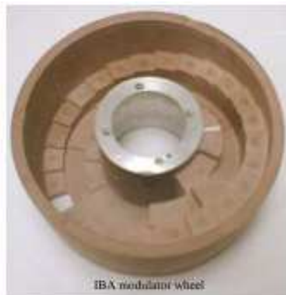
Figure II.3- Une petite roue portant 3 traces de modulateurs utilisée dans la ligne IBA.
