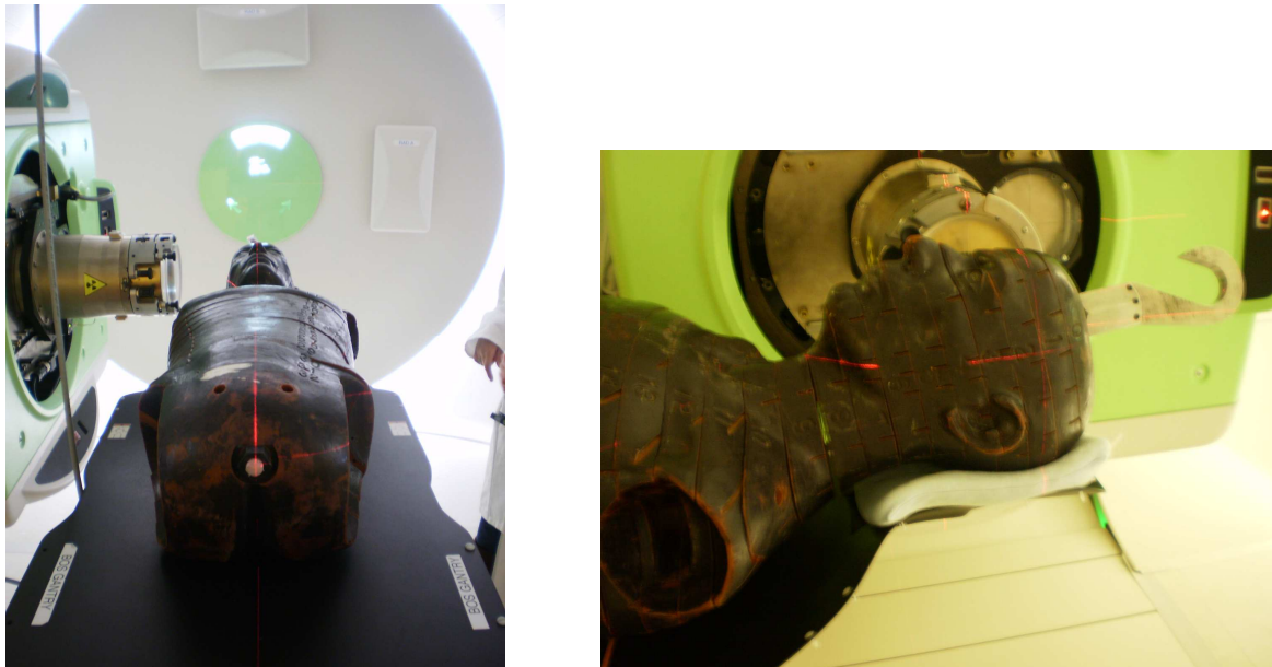
Figure V.5- Irradiation du fantôme Rando à l'ICPO selon l'incidence latérale droite.
