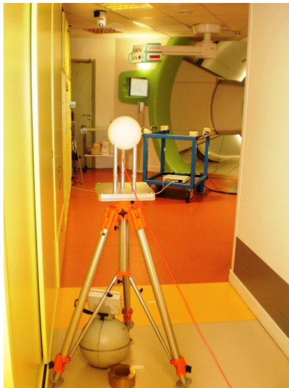
Figure IV.3- Mesure du spectre de neutrons à l'aide des sphères de Bonner du spectromètre HERMEIS au niveau de la chicane de la salle de traitement.
