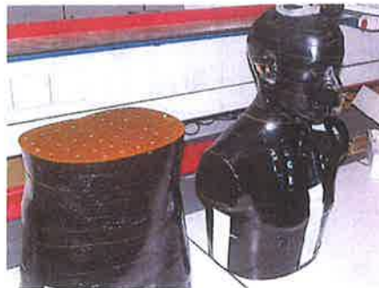
Figure I.5 : Mannequin anthropomorphe équivalent tissu de type Alderson-Rando. Ce fantôme constitué de tranches permet le positionnement de dosimètres (points blancs) dans tout le volume du fantôme permettant ainsi de réaliser une cartographie de dose.
