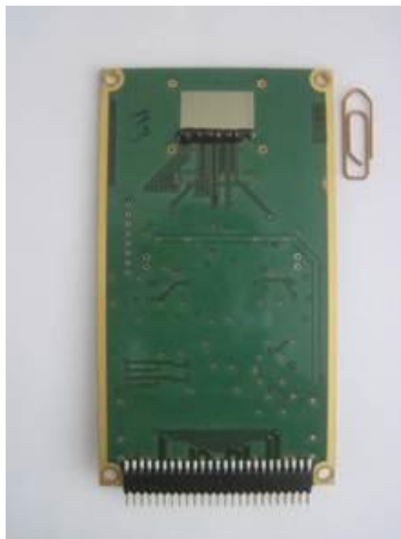
Figure 2-16 : Un des trois capteurs CMOS du TPR-CMOS inséré dans l'électronique d'acquisition associée (carte PCB)
