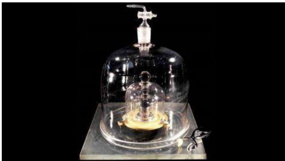
Figure 1-1 : Le kilogramme étalon, conservé au BIPM, composé de 90 % de platine et de 10 % d'iridium
