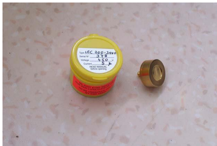
Figure 2-13 : Diode Si(Li) utilisée dans le TPR-CMOS pour la mesure de l'énergie résiduelle des protons de recul
