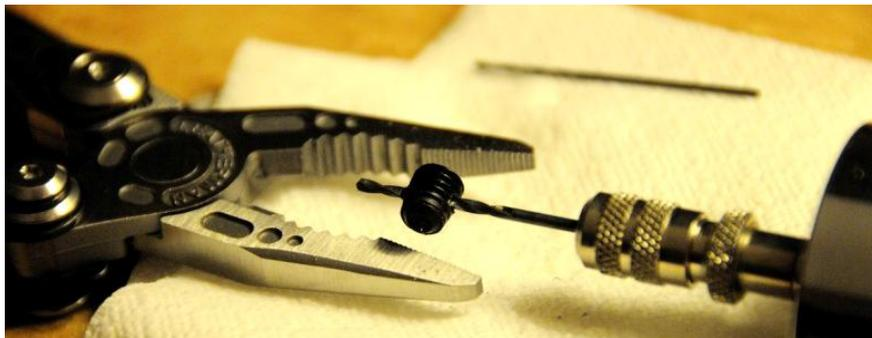
Figure 5.1 : Préparation des fiduciaires de l'EasyCube : perçage des vis pour y incorporer ensuite l'étain.
