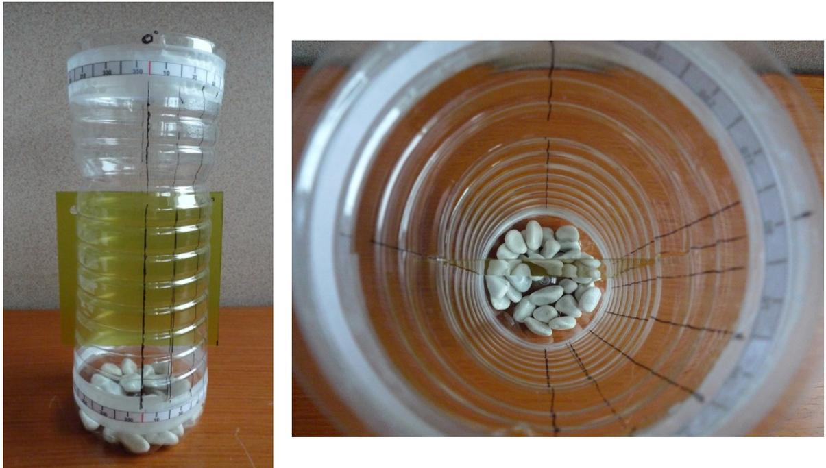
Figure 4.13 : Système de positionnement des films à l'aide d'une bouteille plastique en vue de face (à gauche) et en vue de dessus (à droite).
