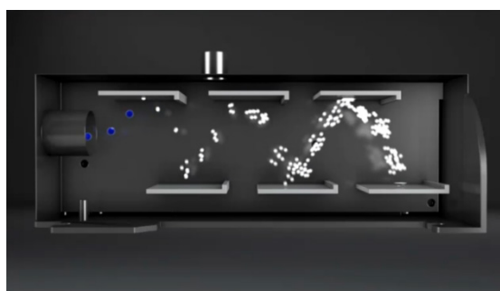
Figure 79 : Représentation du fonctionnement d'un multiplicateur d'électrons à dynodes discrètes (Agilent Technologies ©)
