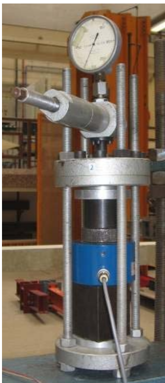
Figure 68 : Etalonnage du bâti de fluage en compression
