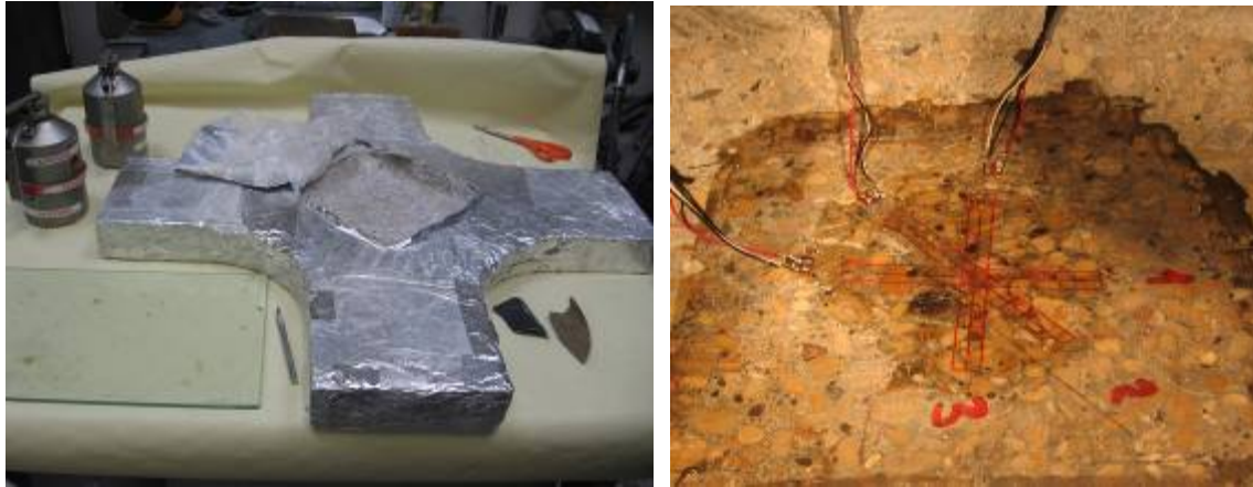
Figure 208 : Collage des jauges : préparation et résultat
