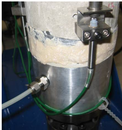
Figure 74 : Dispositif d'injection de gaz dans l'éprouvette.
