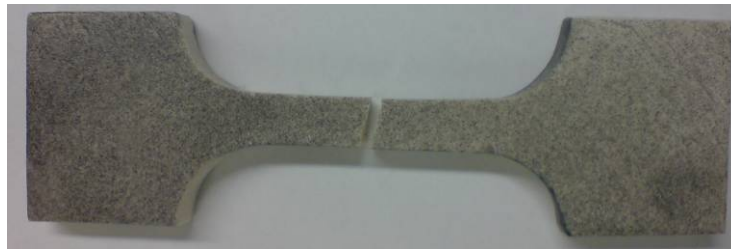
Figure 64 : Rupture de l'éprouvette.
