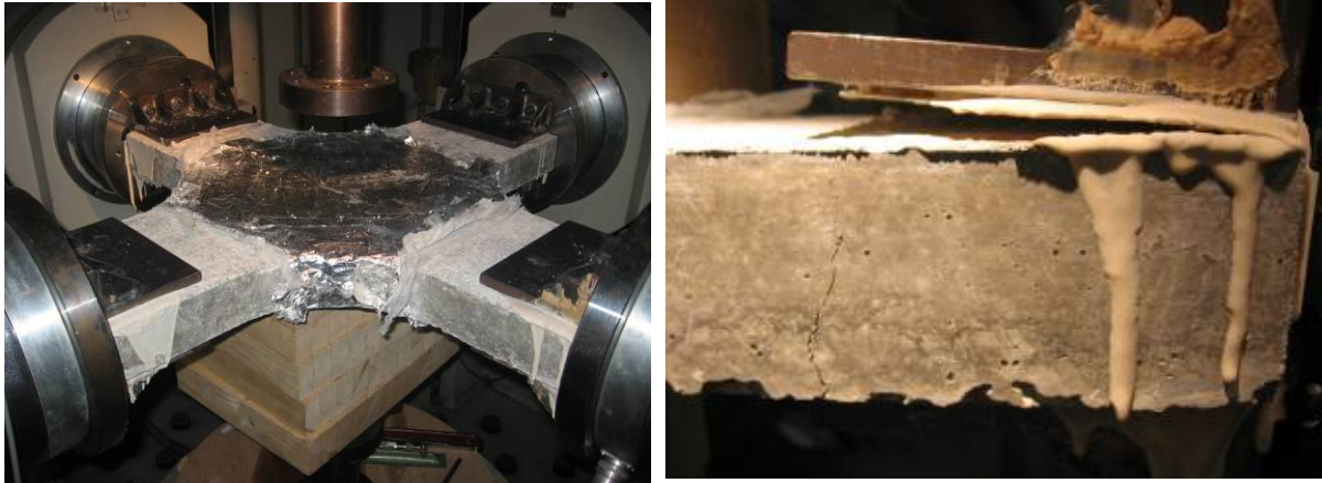
Figure 209 : Test avec éprouvette usinée en condition endogènes au centre
