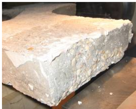
Figure 211 : Bras de l'éprouvette décollé.
