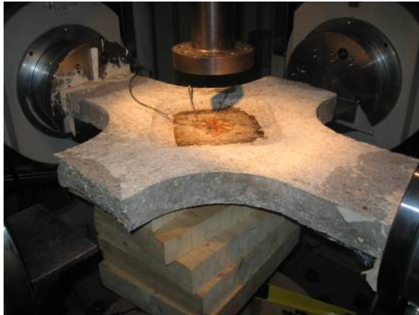
Figure 210 : éprouvette « uniaxiale » instrumentée.
