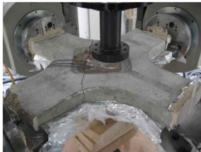
Figure 213 : Rupture de l'éprouvette (déballée après l'essai).
