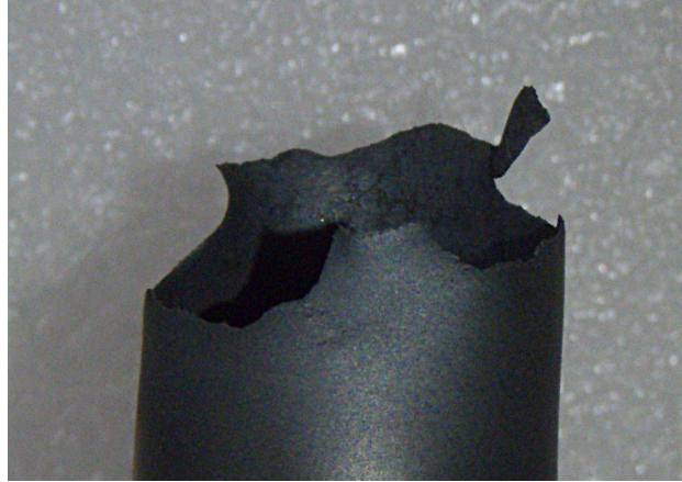
FIG. E.22: Planéité de la trajectoire de la fissure
