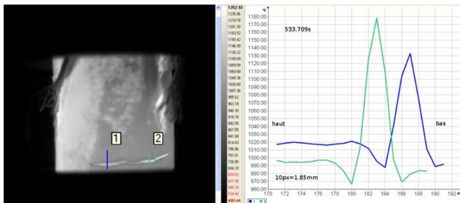
FIG. I.23: Distribution de température mesurée sur un profil coupant la fissure
