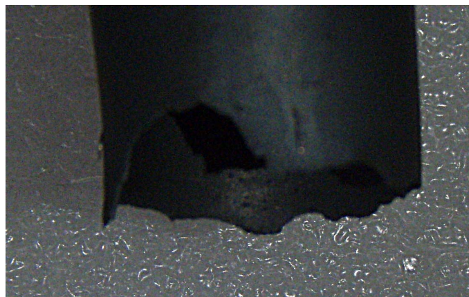
FIG. G.23: Planéité de la trajectoire de la fissure
