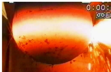
FIG. 1.15: FOREVER : rupture de l'éprouvette [ALS 05]
