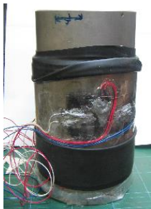
Figure 2-43. Dépôt de la pâte isolante et dépliage de la première membrane
