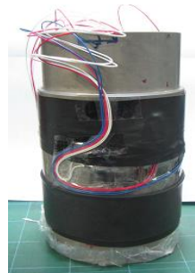
Figure 2-43. Dépôt de la pâte isolante et dépliage de la première membrane
