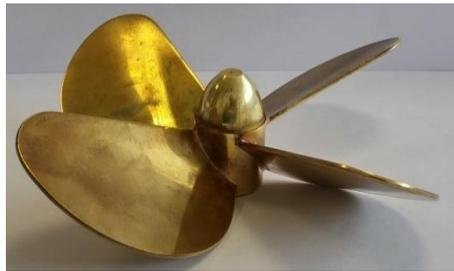
Figure 36 : Hélice quadripale de 130 mm de diamètre.
