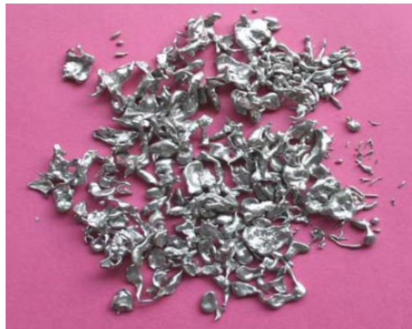
Figure 8-8 : Morphologie de débris indiquant une solidification avant fragmentation complète (IGCAR, (Narayanan et al., 2006))
