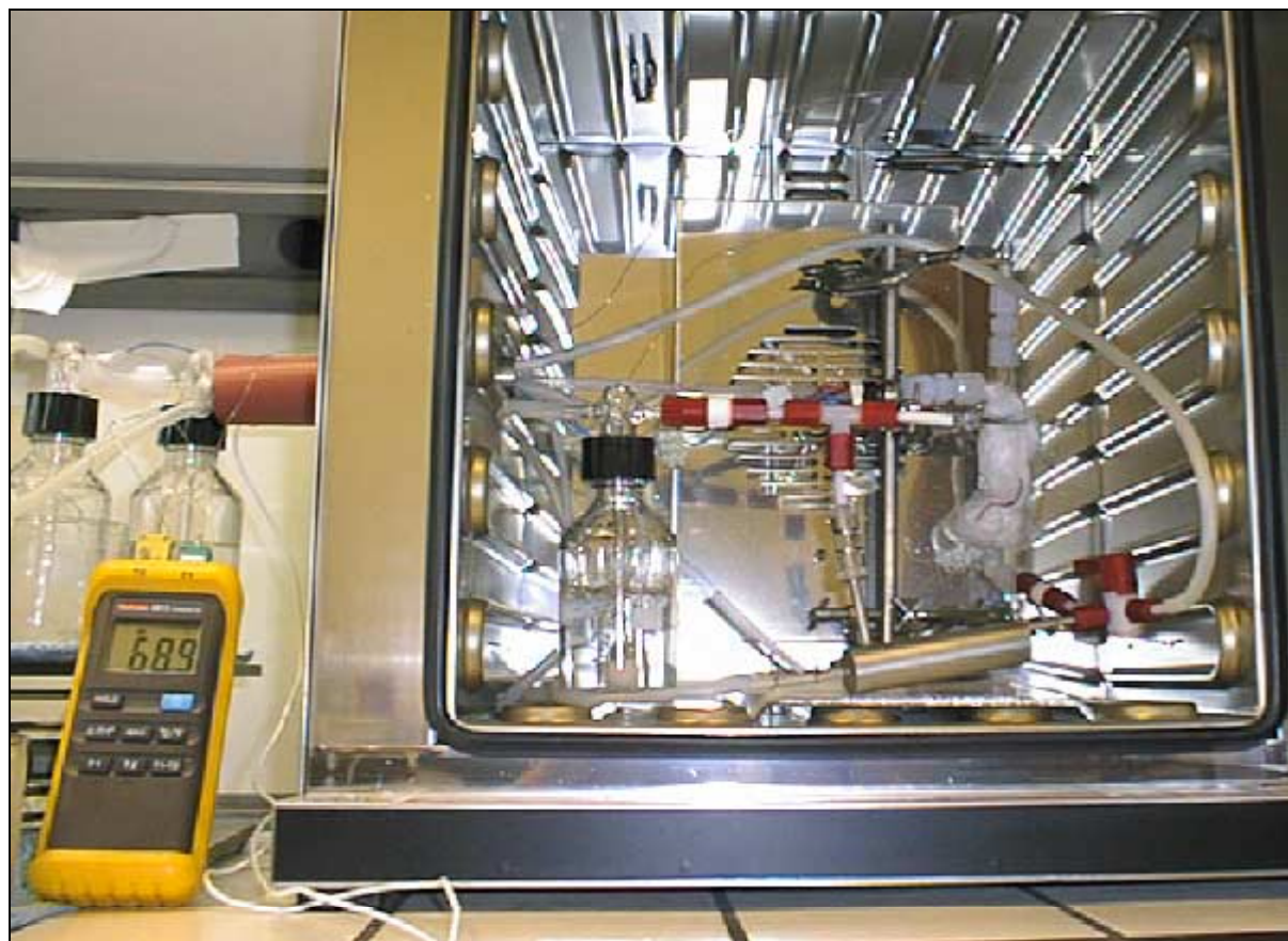
Figure 69 : photographie du banc expérimental d'étude de l'empoisonnement par les vapeurs provenant d'un dépôt de particules de di-iodure ou d'iode.
