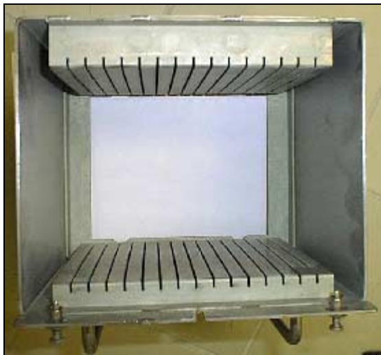
Figure 10 : tiroir du recombineur SIEMENS sans ses éléments catalytiques (vu de dessus).
