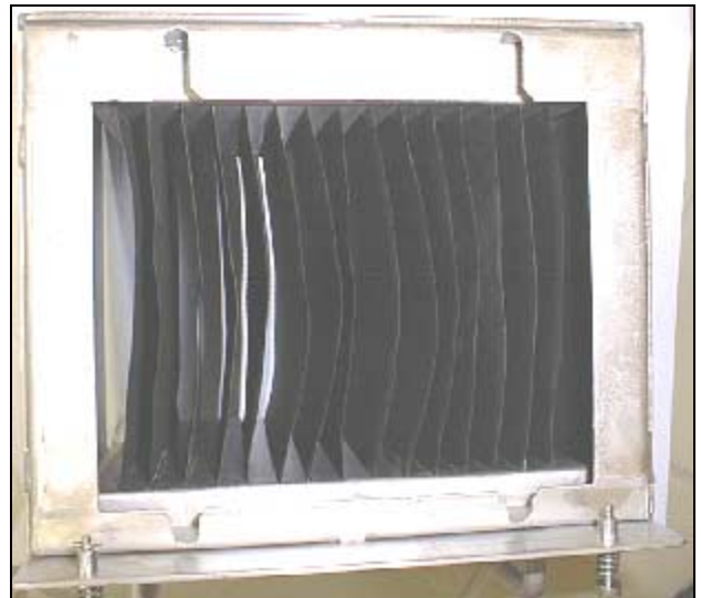
Figure 11 : tiroir du recombineur SIEMENS avec ses éléments catalytiques (vu de dessous).
