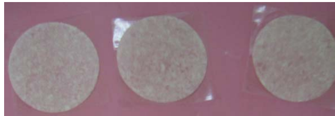
Figure III.8 : Trois pellicules d'un même filtre montrant l'homogénéité des couches de fibres prélevées sur la surface d'un ruban adhésif.
