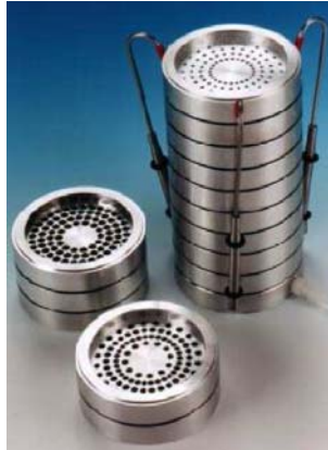
Figure II.4 : Photographie de l'Andersen en cascade Mark II montrant une succession d'étages.
