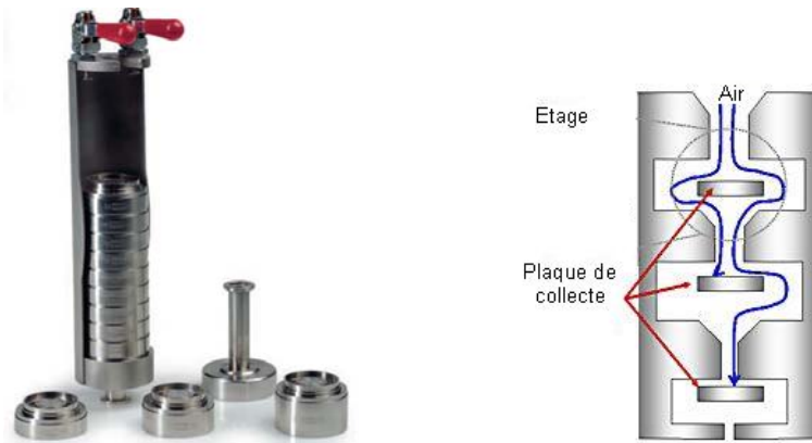
Figure II.7 : Photographie du LPI (à gauche) et schéma de principe du fonctionnement par impaction (à droite).
