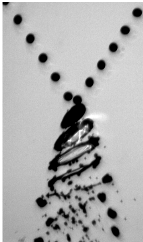
Figure 67. Régime d'étirement avec digitations pour des gouttes d'eau ( We_s = 573 , b = 0,73 , \Delta = 1 , d = 450 \mu\text{m} ).
