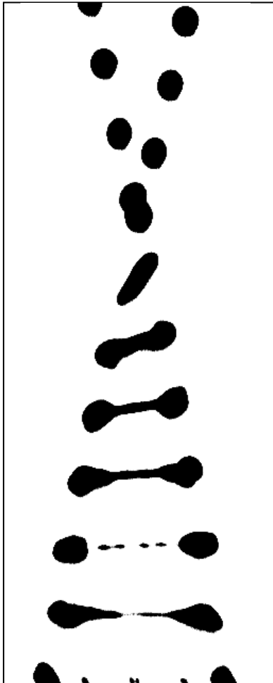
Figure 17. Séparation par étirement de gouttelettes d'eau, Rabe [83] ( \Delta = 1 , We_s = 45 , b = 0,56 ).
