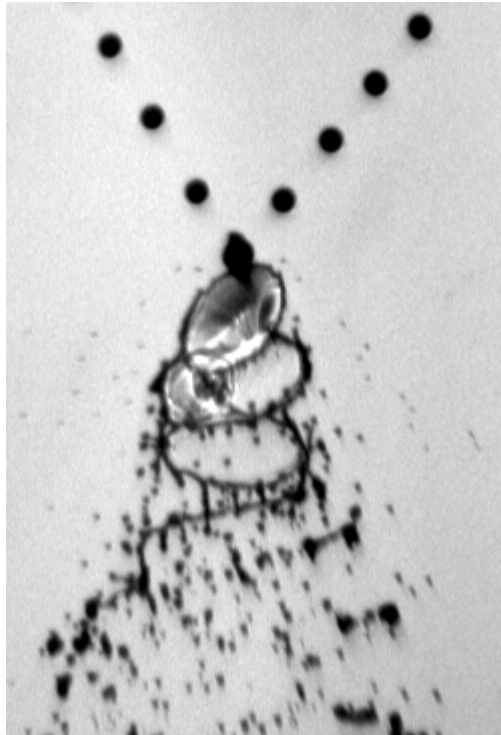
Figure 66. Régime d'éclatement pour des gouttes d'eau ( We_s = 1114 , b = 0,14 , \Delta = 1 , d = 220 \mu\text{m} ).
