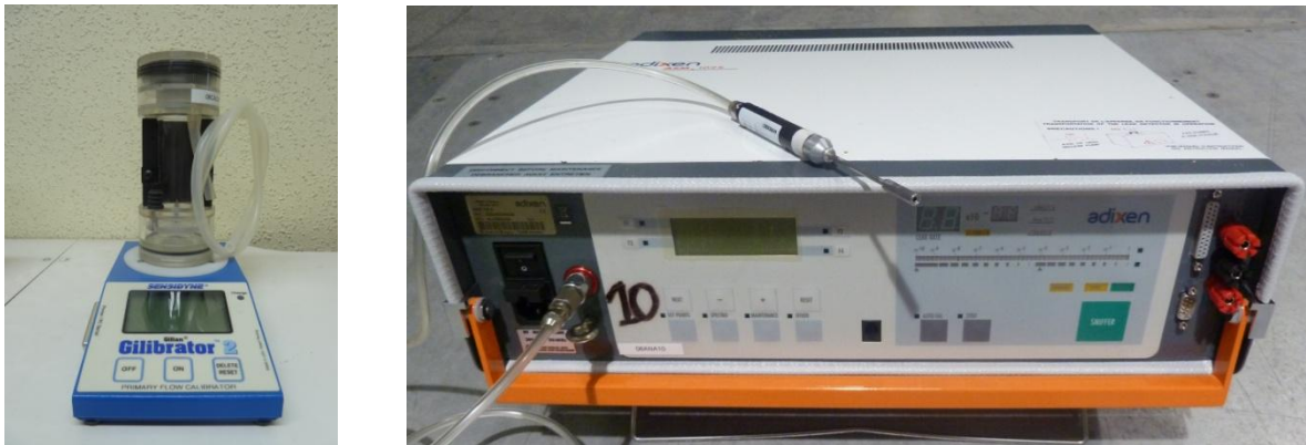
Figure III. 11 : Vue d'un débitmètre à bulle (image de gauche) et d'un spectromètre de masse et de sa sonde de prélèvement (image de droite).
