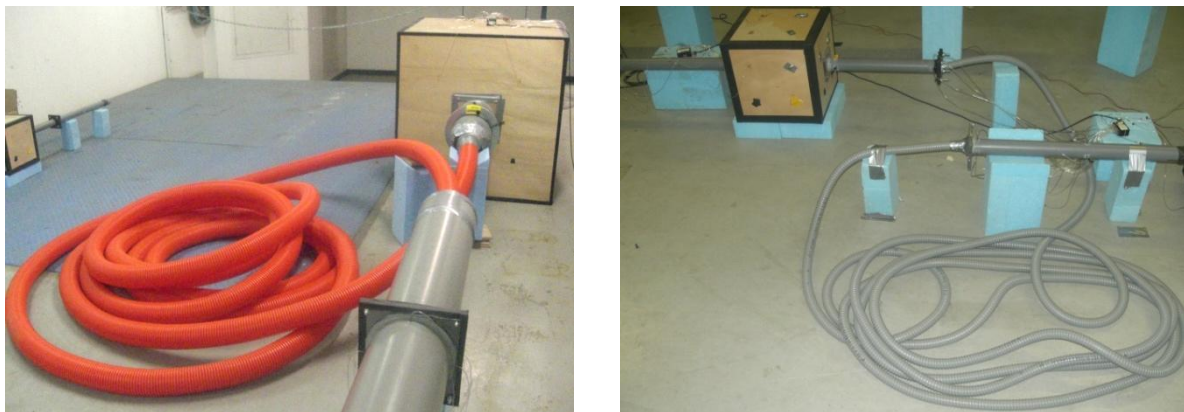
Figure II. 10 : Visualisation des maquettes dites « inertielles » - Maquette de référence (image de gauche) et maquette réduite (image de droite).
