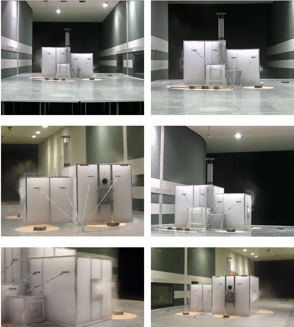
Figure A8. 1 : Vues des inversions de débits de fuite externes des locaux A et B (réseau de ventilation à l'arrêt, vitesse du vent de 36 m/s, configuration I).
