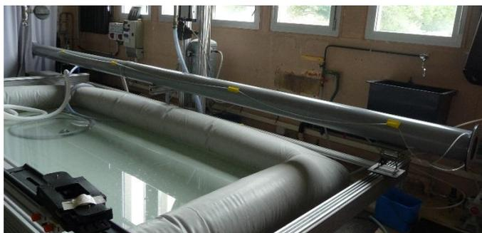
*Figure 2-11 : longueur droite en PVC pour l'établissement de la turbulence du conduit cylindrique*
