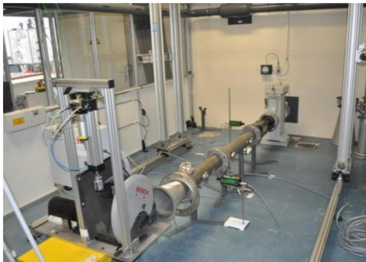
**Figure 28 - Photo illustrant une configuration de la conduite de ventilation et du filtre TEST sur l'installation CAPIMIF**
