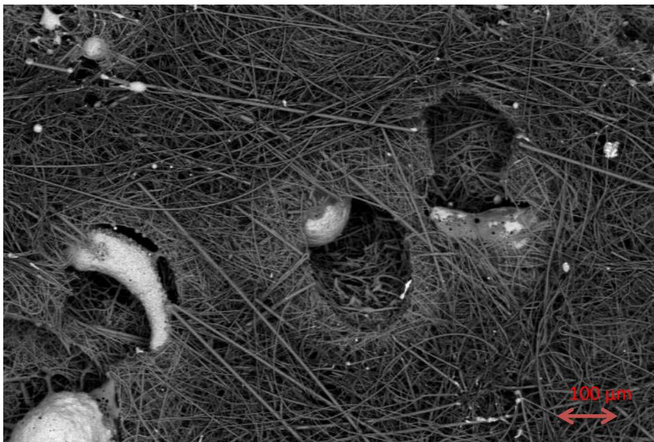
Figure 138 - Visualisation au MEB d'un filtre impacté par des particules à 60 cm de l'émission
