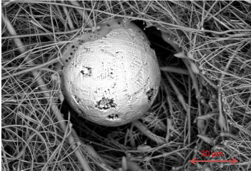
**Figure 98 - Visualisation au MEB d'un filtre impacté par une particule solide à 60 cm de l'émission (famille 1)**
