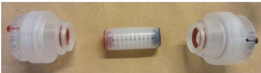
Figure 15 : Chambre de focalisation (au centre) et les deux réservoirs cathodiques et anodiques
