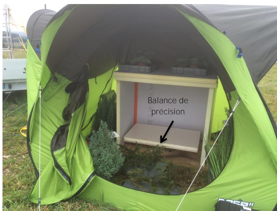
Figure 3.12 - Tente dans laquelle sont placées la balance de précision et la chambre de protection représentée ici avec le panneau avant enlevé permettant ainsi de déposer le bac à peser sur le plateau de la balance situé sous la plaque de polystyrène en partie basse.
