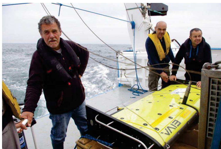
Photo 4.1 – Appareil de mesure multicapteurs Scanfish™ sur le pont du navire océanographique Côtes de la Manche durant la campagne PLUME.
