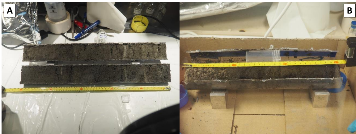
Figure II-7 – Découpage des carottes en boîte à gants anoxique avant sous-échantillonnage : (A) segment de carotte de sédiments du lac (NEG18-07C) permettant d'observer les couches et lentilles grises détritiques ; (B) carotte C2 extraite dans la zone humide ZH1, très organique sur un fond sableux. Le sommet de chaque carotte est situé à droite. Photos P. Lefebvre et P. Le Pape.
