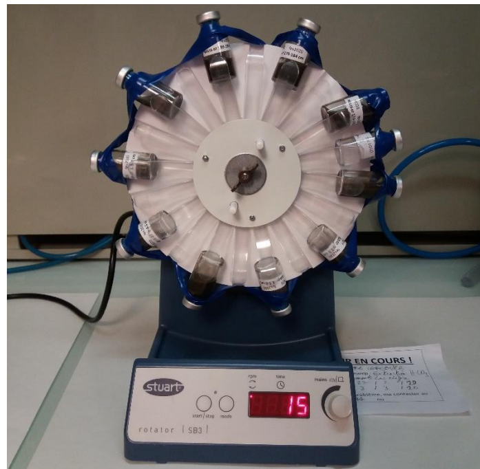
Figure II-16 – Flacons scellés placés sur agitateur rotatif pendant les extractions au bicarbonate 1 M de sédiments lacustres (carotte NEG18-07).
