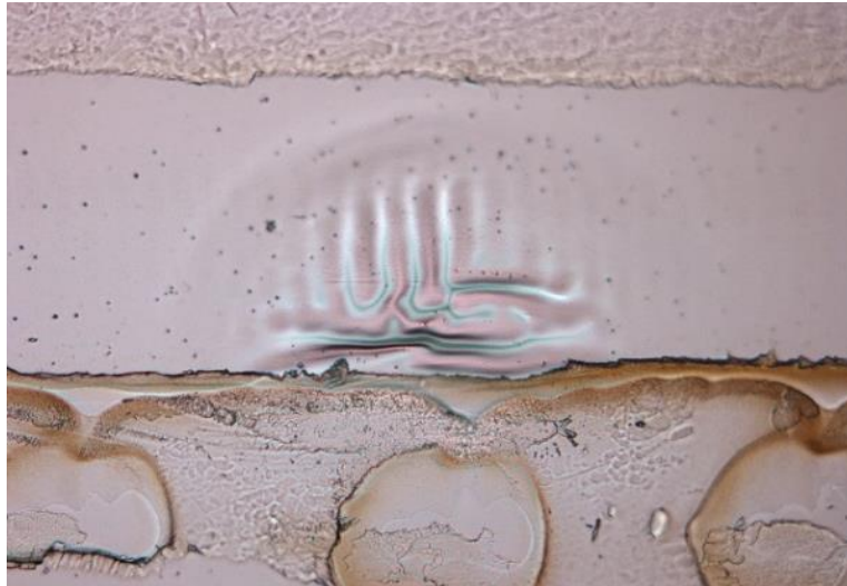
Figure 2 – Observation d’une déformation localisée sur la plaque n°21 face T après 120 jours d’immersion dans 16% d’HCl
