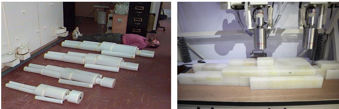
Figure 1.6. Fantômes d'étalonnage de la mesure corps entier : (à gauche) la famille de fantôme BOMAB, (à droite) le fantôme IGOR dans la géométrie de référence.
