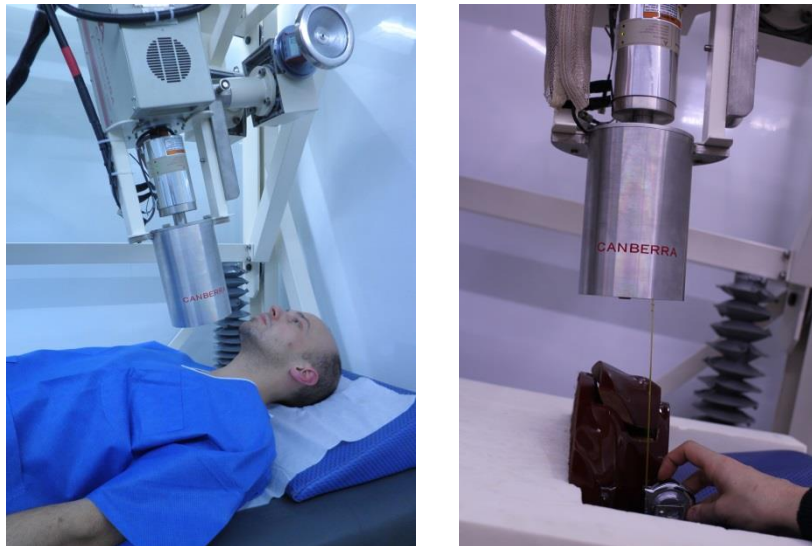
Figure 1.5. Illustration de l'anthroporadiométrie thyroïdienne en condition d'examen (à gauche) et de l'étalonnage de la mesure thyroïdienne avec le fantôme RSD (à droite).
