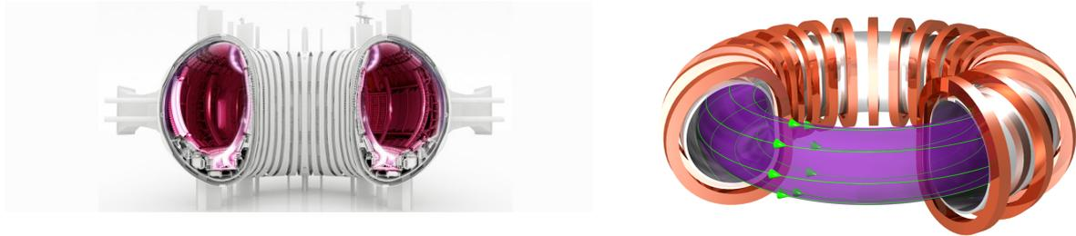
Figure 2 – Schéma d'un tokamak suivant une vue de face [2] (à gauche) et une vue de côté [3] (à droite) avec en vert le courant électrique axial qui circule dans le plasma
