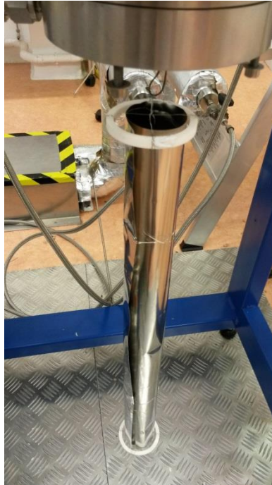
Figure 33. Feuille d'acier 316L fixée dans le porte-échantillon
