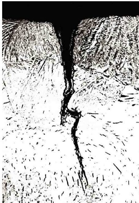
FIGURE 1.5. – Phénomène de Delayed Hydride Cracking [164].
