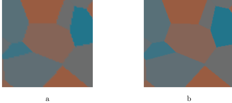
FIGURE 8.2 – Coupes des cellules unitaires représentatives du polycristal comptant 512 grains. a : Cellule discrétisée par 256^3 voxels. b : Cellule discrétisée par 512^3 voxels.
