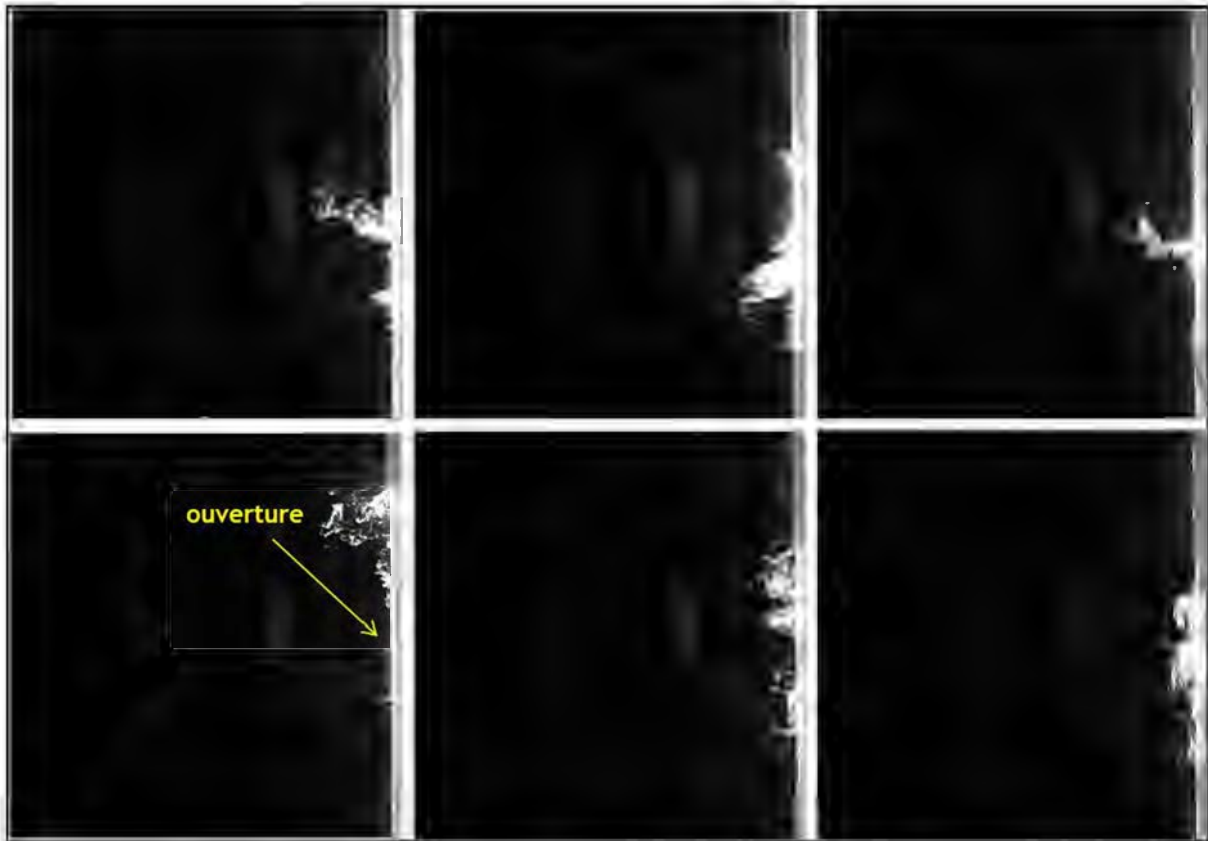
Figure 4.10 : visualisation des champs externes instantanés successifs (de gauche à droite) dans le plan vertical médian de l'ouverture, configuration 2 - V/U_{deb} = 8,3
