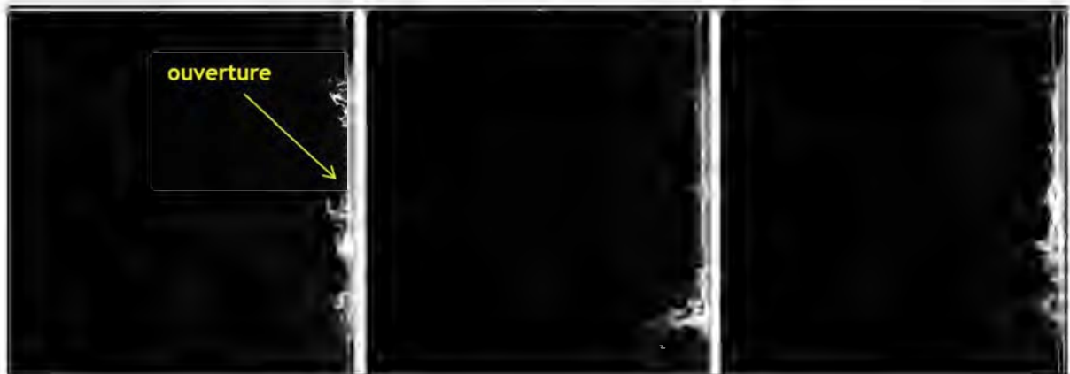
Figure 4.11 : visualisation des champs externes instantanés successifs (de gauche à droite) dans le plan vertical médian de l'ouverture, configuration 3 - V/U_{deb} = 6,8
