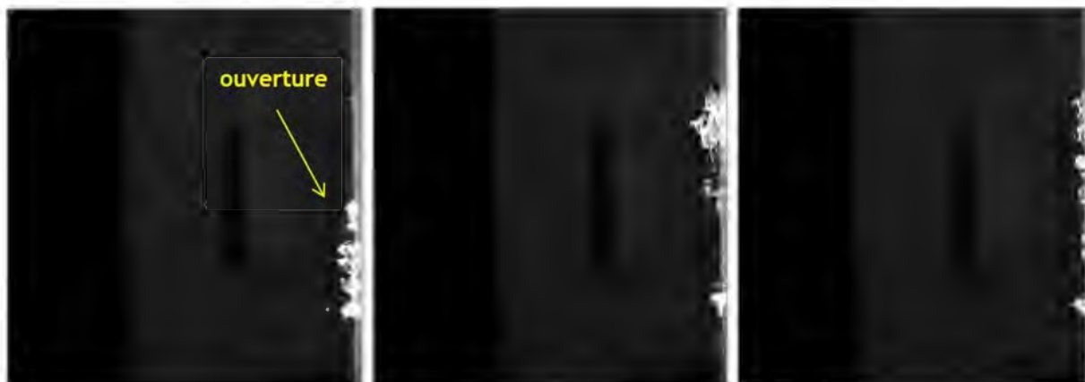
Figure 4.12 : visualisation des champs externes instantanés successifs (de gauche à droite) dans le plan vertical médian de l'ouverture, configuration 4 - V/U_{déb} = 5
