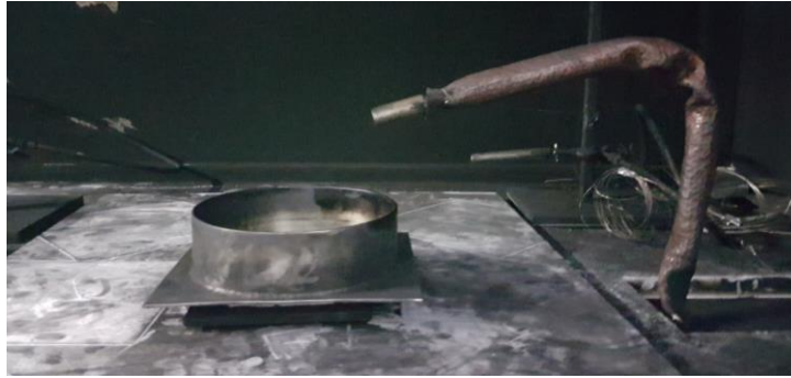
Figure 24 : Brûleur à propane utilisé pour l'inflammation de la nappe d'hydrocarbure.
