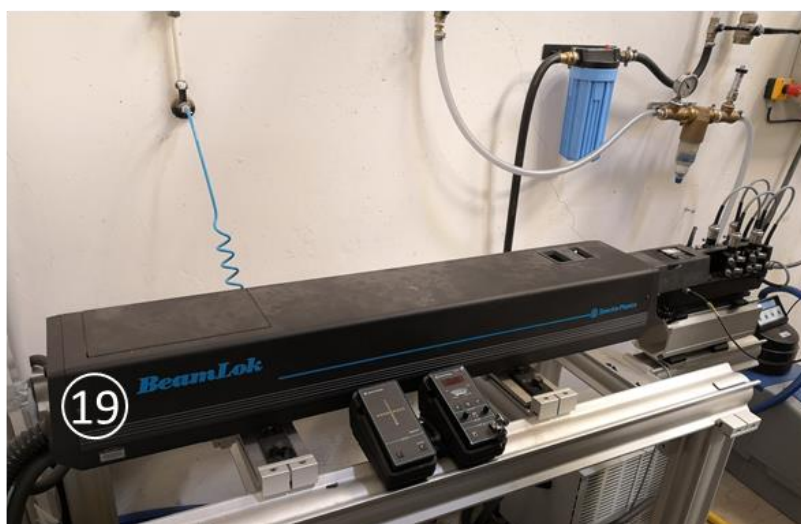
Figure A.3. Photographie de l'installation expérimentale : (15) générateur de vapeur, (16) surchauffeur de vapeur, (17) générateur électrique, (18) générateur de fréquences d'injecteur de gouttes, (19) laser.
