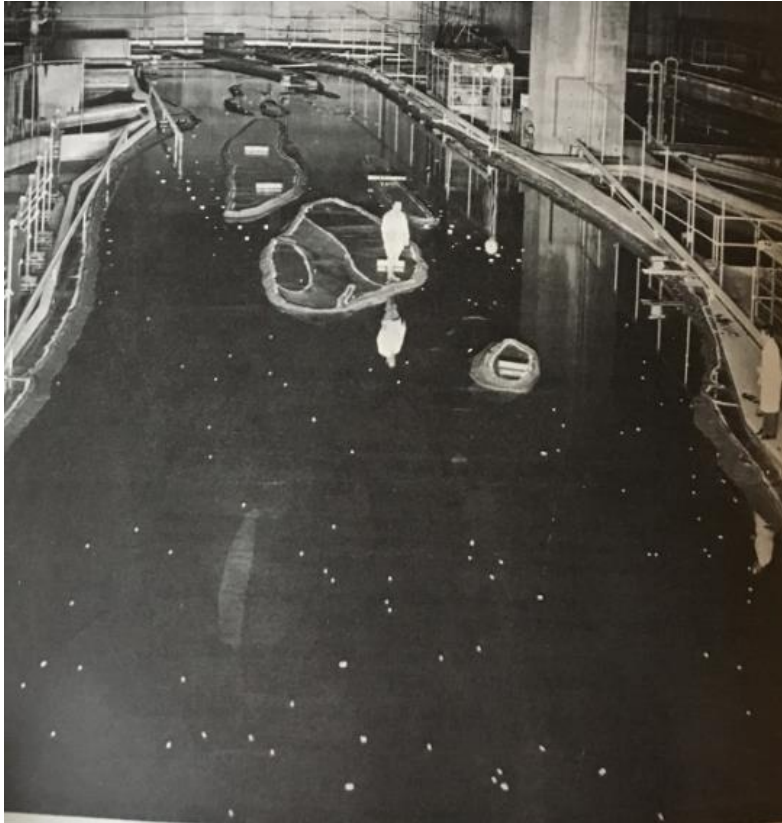
Figure 90 : Modèle réduit de l'estuaire de la Gironde, LNH informations, 1979
