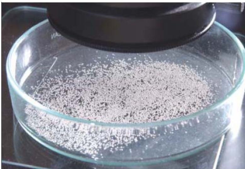
Figure 14 : Billes de combustible HTR TRISO élaborées dans l'installation Gaia du laboratoire UO 2 au centre CEA de Cadarache. Crédit photo : CEA
