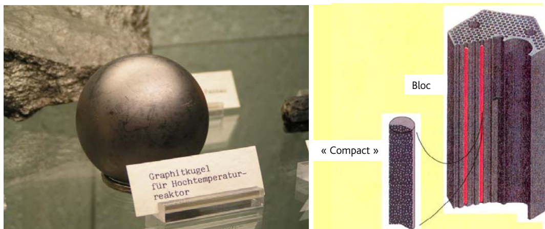
Figure 1 : A gauche : un boulet de réacteur. A droite : « compact » et bloc de combustible de réacteurs à haute ou très haute température.
