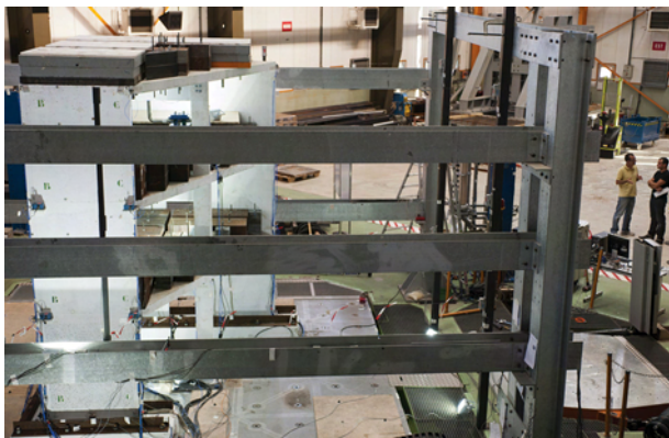
Figure 10.17. La maquette instrumentée SMART2011 (en support à un programme de recherche commun CEA/EDF) est représentative d'un bâtiment de « type nucléaire » à l'échelle 1/4. D'une masse d'environ 47 tonnes (incluant 36 tonnes de masses additionnelles), elle est instrumentée avec plus de 200 voies de mesure (accélération, déplacements, déformations) et subit une séquence de sept séismes de niveau croissant. © P. Stroppa/CEA.
