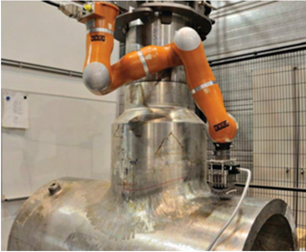
Figure 10.8. Contrôle d'un piquage à l'aide d'un traducteur conformable (conférence Cofrend 2014 – stratégie pour l'inspection robotisée de composants nucléaires : de la conception du contrôle aux résultats expérimentaux). © CEA.
