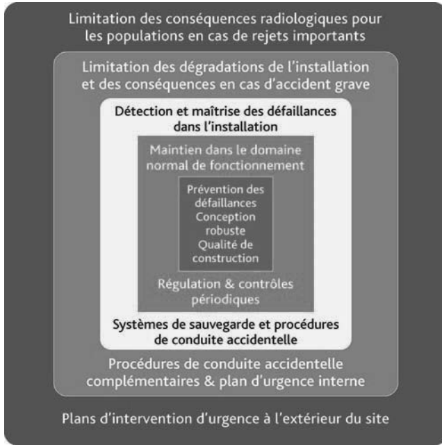
Figure 3.3. Le concept de défense en profondeur tel que développé dans le rapport INSAG-10 : objectifs et moyens. © Georges Goué/IRSN.
