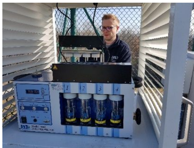
Figure 21 : Barboteur tritium à quatre pots installé au point AS 1 du CNPE de Saint-Alban Saint-Maurice
