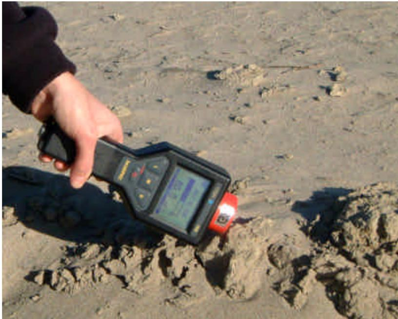
**Figure 2 : Mesure du débit de dose au point n°1 (zone de forts dépôts de sables, 50 mètres face au point de rupture de la digue)**
