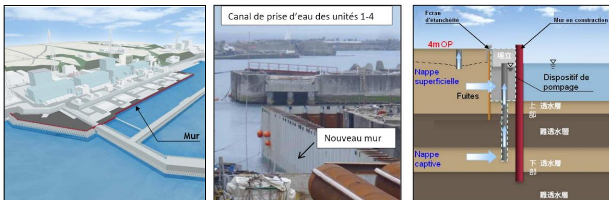
Sur la base de données TEPCO - Barrière d'étanchéité côté port
