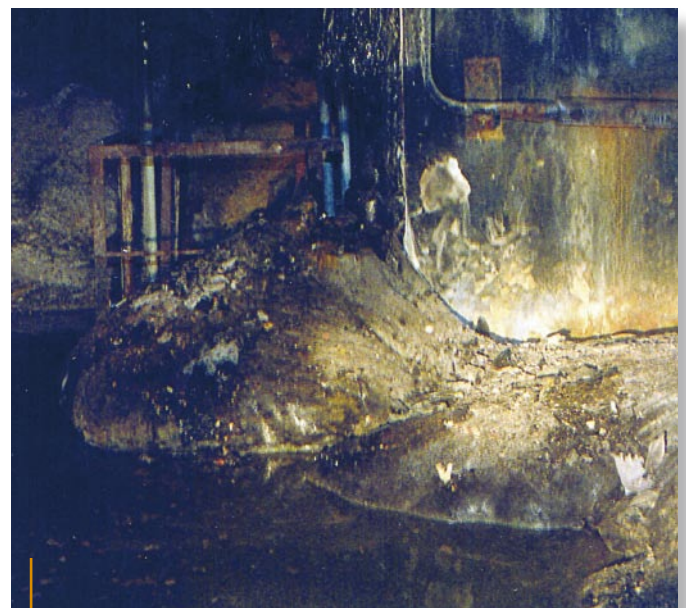
Der „Elefanten-Fuß“ (erstarrte Brennstofflava) im Raum 217/2
