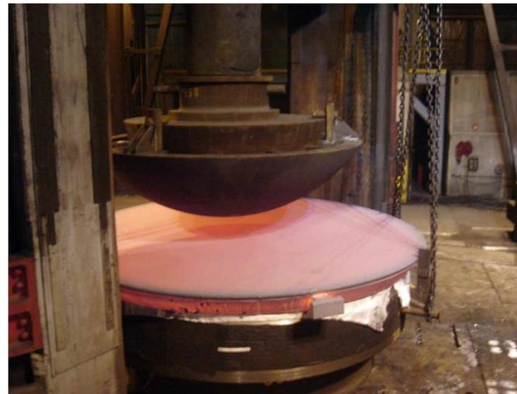
Emboutissage de la calotte supérieure de la cuve de l'EPR de Flamanville 3
