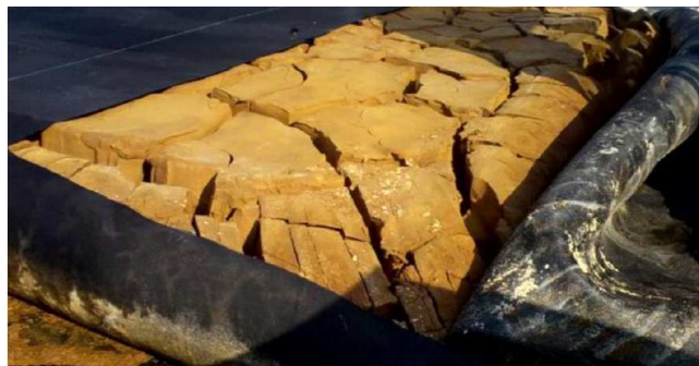
Figure 3. Illustration des boues séchées dans un géotube (Source AREVA NC)
