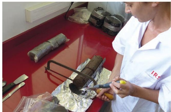
Figure 11. Prélèvement de sol et découpe en laboratoire d'une carotte par section.
