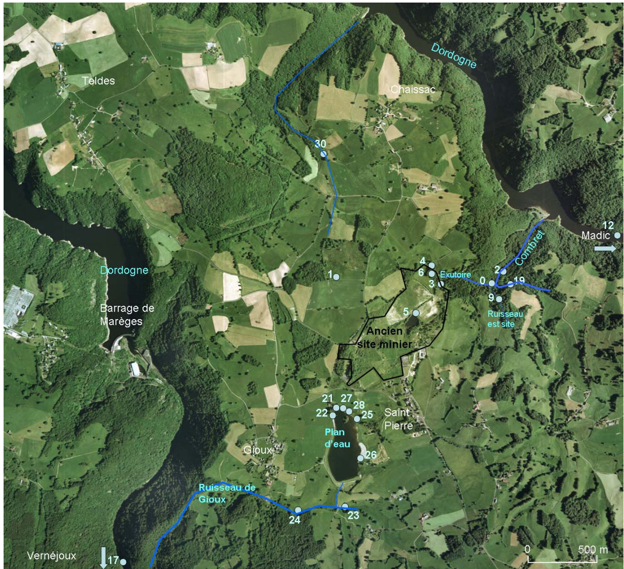
Figure 11 : Carte des points de prélèvement d'eau de surface sur la commune de Saint Pierre (d'après photographie aérienne IGN)
