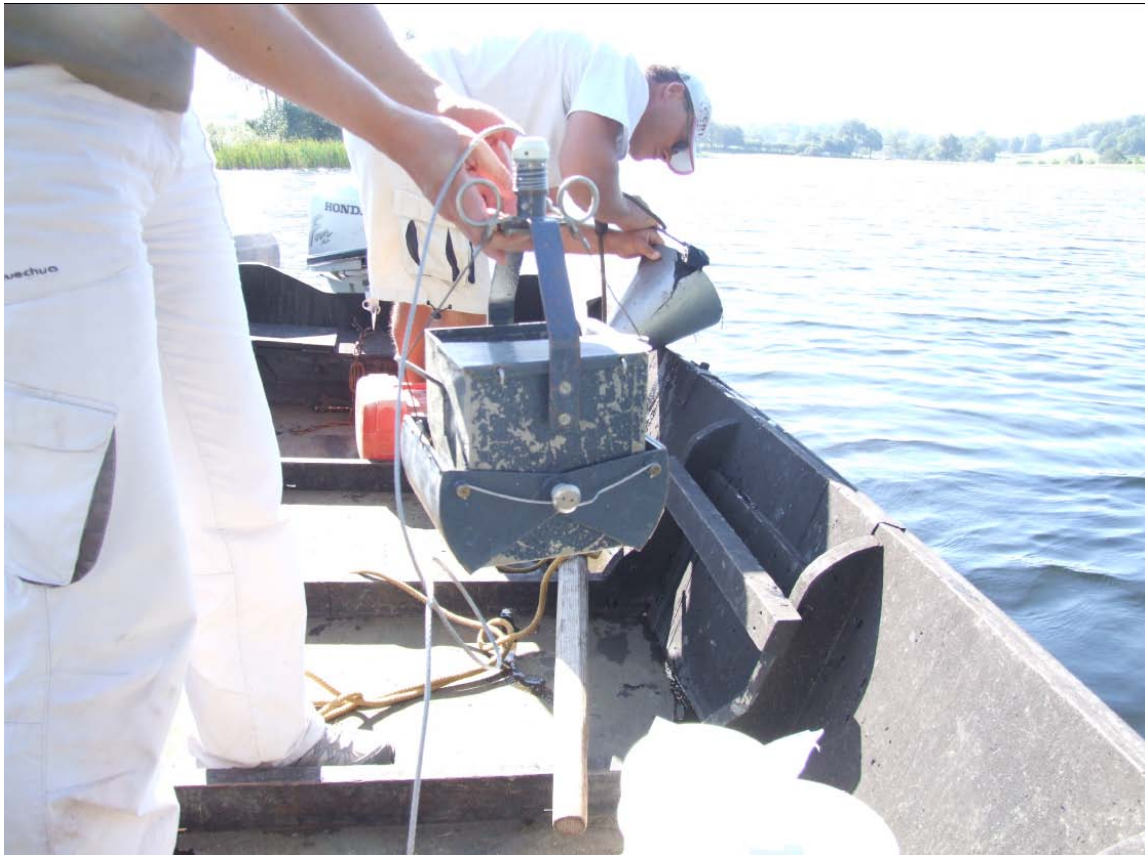
Photo 2 : Prélèvements de sédiments dans le plan d'eau à la micro-benne et au cône de Berthois
